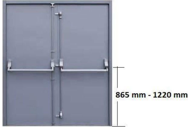
شكل ٣,٤: ارتفاع أجهزة الذعر من الأرضية النهائية
